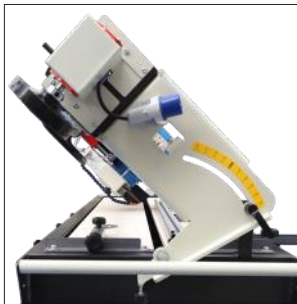
کله اسبی تقویت شده و مستحکم جهت افزایش دقت برش
