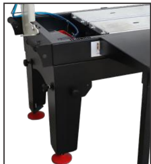
تقویت کامل وان دستگاہ جهت استحکام بیشتر برای برش اسلب
