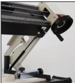
جک های گازی جهت کمک به تنظیم حالت فارسی بری
