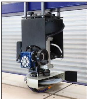
گلوبی انتقال قدرت و قابلیت گردش صفحه موتور به وضعیت ۹۰ درجه به وسیله گیربکس
