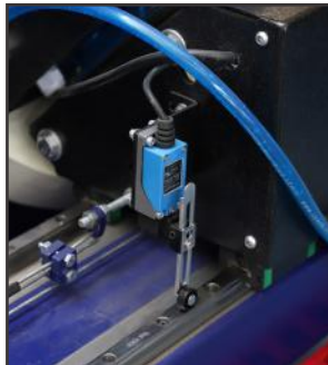
مجهز به میکرو سوئیچ جهت حرکت اتوماتیک
